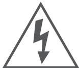
Предупреждение пользователя о наличии неизолированного «опасного напряжения» внутри корпуса устройства, которое опасно для здоровья и жизни человека
